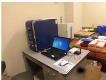
図 2-1. 日立卓上顕微鏡 TM3030 外観
